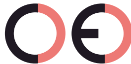
Falsche CE-Kennzeichnung (zu großer Zwischenraum)
