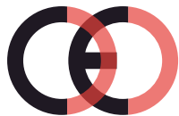
Falsche CE-Kennzeichnung (zu dicht)
